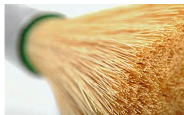
△ Die Hohlfasern ähneln Spaghettis. Mit ihnen lassen sich Gase trennen.
